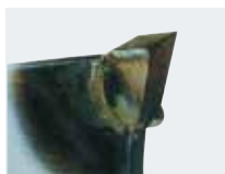
Stellitierter Zahn im Widerstands-Schweißverfahren
