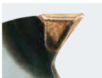
Stellitierter Zahn im Plasma-Schweißverfahren
