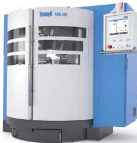
Bearbeitung von Span- und Freifläche in nur einer Aufspannung.
