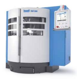
Die Zahngeometrie wird in nur einer Einstellung geschliffen. Jedes Sägeblatt wird beim Einfahren in die Schleifstellung automatisch durchmesserunabhängig positioniert. Anschliessend vermisst ein Messtaster die Zahngeometrien.
