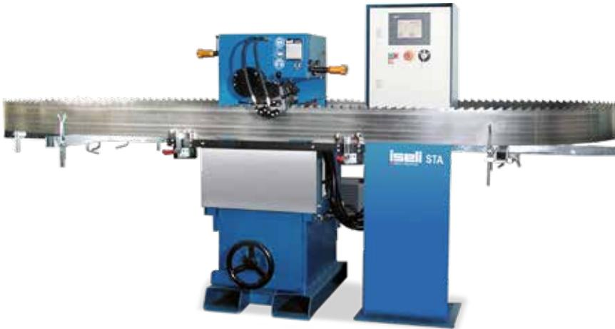
Das Stauchen von Sägezähnen ist neben dem Schränken eine weitere Möglichkeit, um das Freischneiden der Säge beim Zerspanen zu gewährleisten. Für den Stauchvorgang wird ein Stauchbolzen vor den Sägezahn gesetzt. Der Sägezahn wird mit einem Amboss gegengehalten. Durch Verdrehen des exzentrischen Stauchbolzens wird das Sägenmaterial zur Zahnschulter hin verdrängt. Ist der Stauchvorgang beendet, dreht sich der Stauchbolzen wieder in seine Ausgangsstellung zurück.
