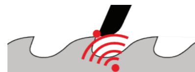
Automatisches Antasten des Werkzeug- nullpunkt mit Akustiksensoren
